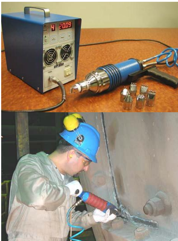
Рис.1. Зовнішній вигляд та приклад використання ультразвукового пристрою для оброблення зварних з'єднань
