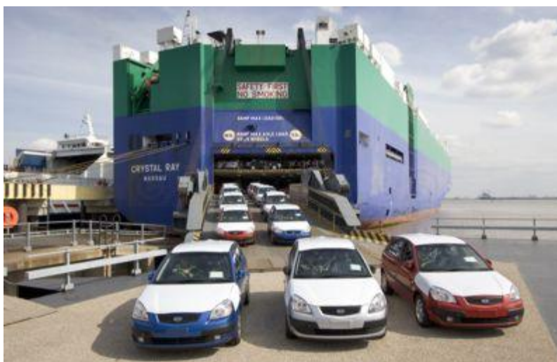
Рис. 1. Процесс выгрузки автомобилей с судна типа RO-RO вместимостью 3500 автомобилей
